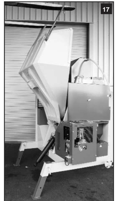
Retire los frenos del eje superior del cilindro (debajo del skip) y retire el eje (imagen 18). Coloque protección en el piso debajo del cilindro (ejemplo: un trozo de cartón – imagen 19).
