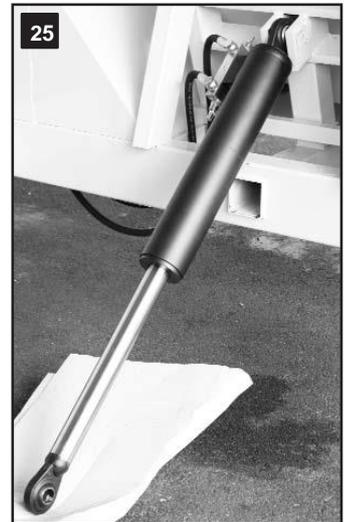
Alinee el orificio de la varilla del cilindro con los orificios del skip. Una vez alineado, inserte el eje (imagen 26). Se puede utilizar un martillo, teniendo cuidado de no dañar el eje. Introducir completamente (imagen 27) y bloquear junto con el freno (imagen 28)
